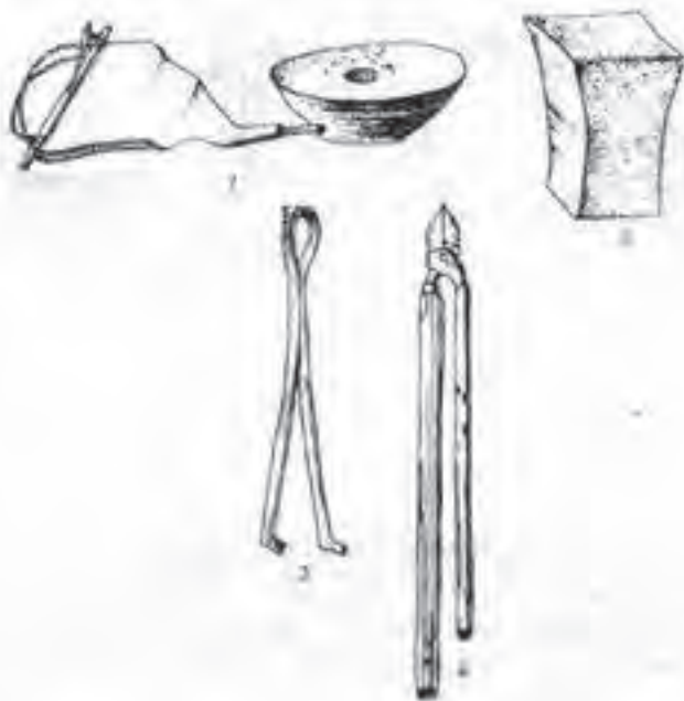
الرسم (13): أدوات الحداد: 1- كبر محمول 2- السندان 3- ملقط 4- قاطعة للصفيح
